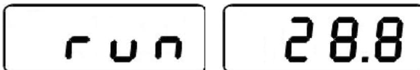
Después de tomar la medida el medidor se apaga solo. El medidor está entonces listo para tomar una nueva medida.
