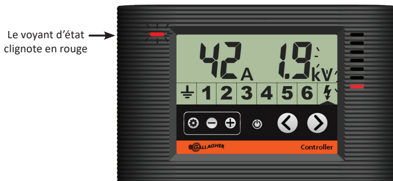
Contrôleur affichant une alarme Intensité sur l'électrificateur
