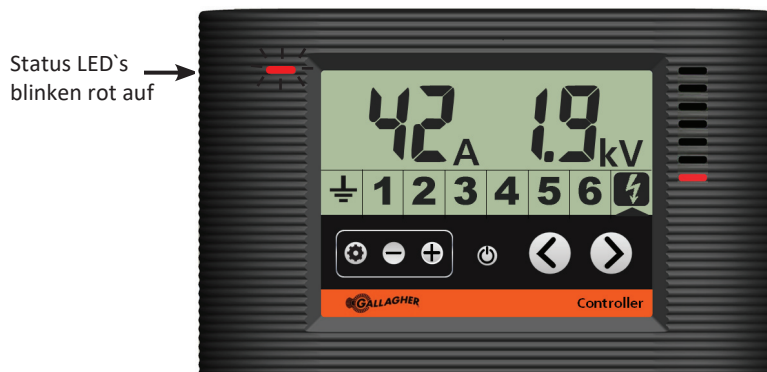
Die Steuereinheit zeigt einen Ausgangsalarm am Elektrozaungerät an
