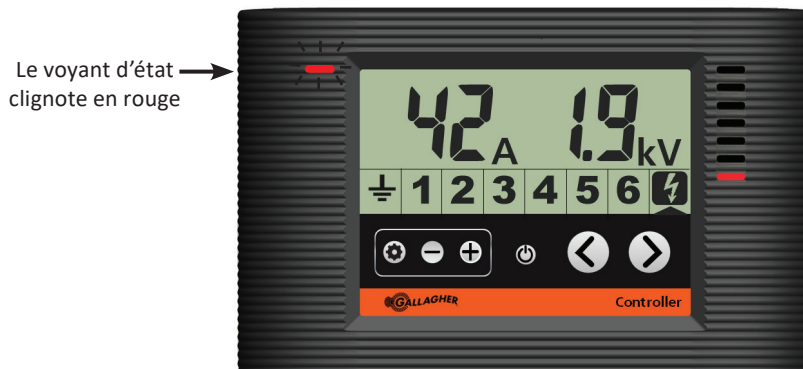
Contrôleur montrant l'électrificateur en état d'alarme
