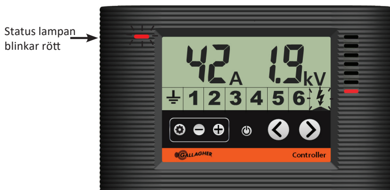
Kontrollen visar aggregat i ström larm
