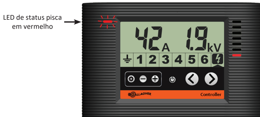
Controlador mostrando o energizador no alarme de saída
