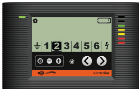
Styreenheden viser zone 2 med et lavt batteri
