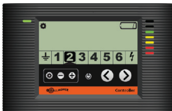
Controlador mostrando la zona 2 con batería baja
