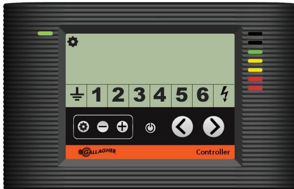
Controlador mostrando el voltaje de salida siendo ajustado
