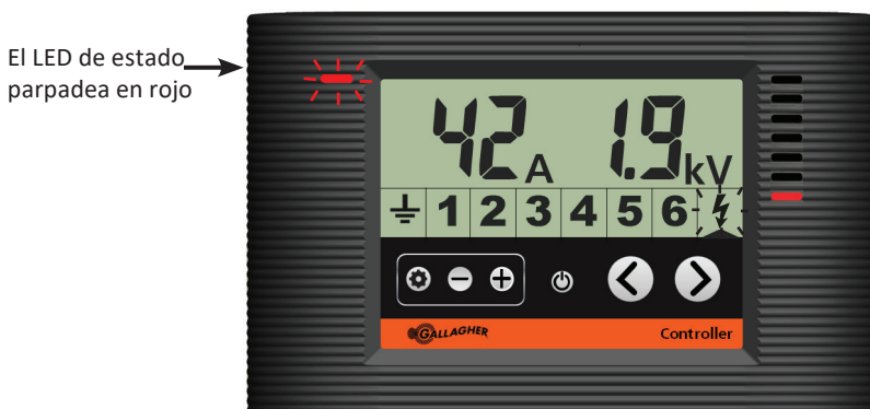
Controlador mostrando el Energizador con alarma de corriente
