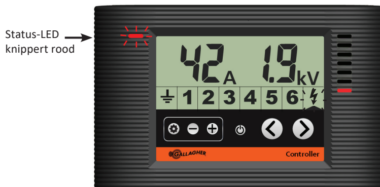
Bedieningspaneel toont het schrikdraadapparaat in stroomsterktealarm
