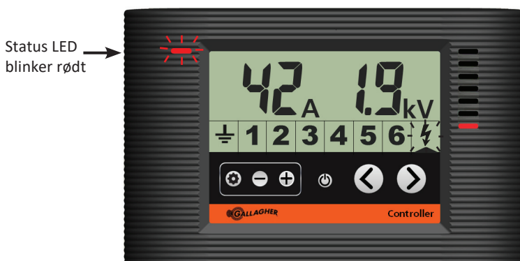
Styreenheden viser energizeren i strømstyrke alarm
