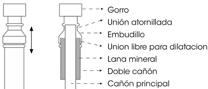
1. Con el calefactor posicionado, localizar el centro del cañón en el techo y hacer una perforación de 38 cms. de diámetro que salga al exterior. En la sección del entretecho debe colocarse un doble cañón para evitar el contacto directo de éste con materiales combustibles. El espacio entre el cañón y el doble cañón se rellenará con lana mineral. Ningún material combustible deberá quedar a menos de 15 cms. del doble cañón.
