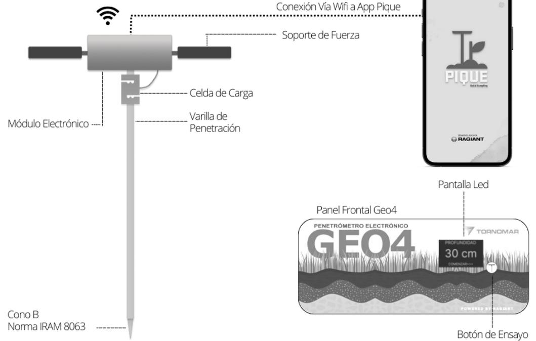
También podrás ver el estado de conexión del penetrómetro. Hasta no iniciar la app y configurar la conexión, el estado será Offline. Más adelante se explicará el paso a paso para conectar tu penetrómetro con la App Pique..
