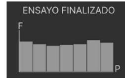
Una vez finalizado el ensayo se mostrará un gráfico con las distintas presiones ejercidas en las distintas profundidades de la penetración.
