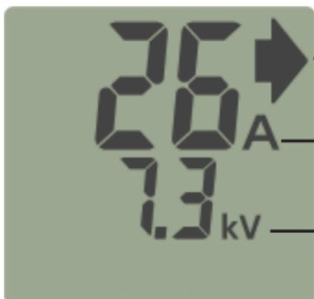
La flecha muestra la dirección de la corriente en la cerca y la dirección del fallo
