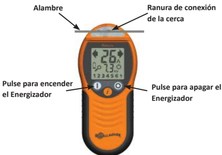
**Nota:** Mantenga el control remoto en la cerca hasta que la pantalla muestre que el energizador está encendido o apagado.
